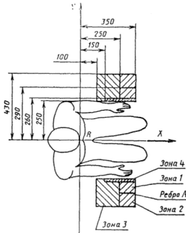
2. Центры рукоятей управления в крайнем положении контроллера и приводные элементы кнопочного управления краном должны располагаться в одной горизонтальной плоскости на расстоянии 120 мм вверх от точки R. Точку R определяют в соответствии с требованиями ГОСТ 20304.
